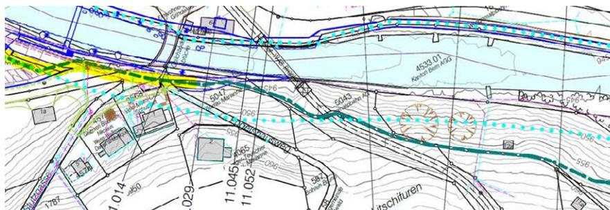
Abb. 8 Ausschnitt aus Baugesuchsplan zur Transportwasserleitung: grün gestrichelt = Transportwasserleitung; gelb markiert der bereits erstellte Teil. Vgl. 2.1.3 Option Verbindung Litschifuren–Parkplatz Chilchboden, sofern die Leitung allenfalls dereinst in Kombination mit Piste gebaut wird.
